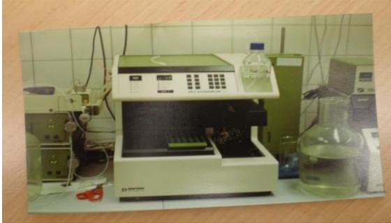
Abb. 9: HPLC-Anlage
